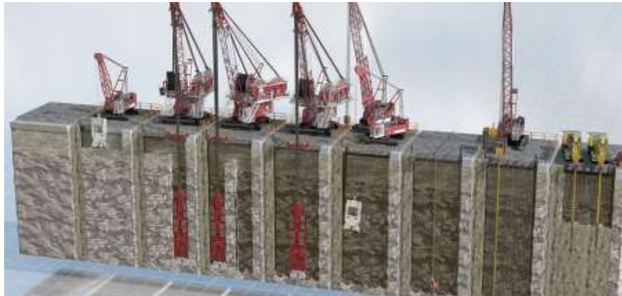
ILUSTRACIÓN 6 - ESQUEMA GENERAL DE EJECUCIÓN DE MUROS PANTALLA CON HIDROFRESA (FUENTE: SOLETANCHE BACHY)
